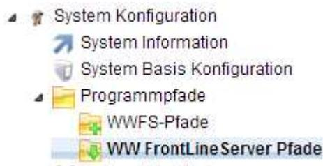
Die Pfade für die Integration des WWFLIS mit dem WW-Server werden im System-Cockpit im Bereich System-Konfiguration > Programmpfade > WW-FrontLineServer Pfade angegeben.
