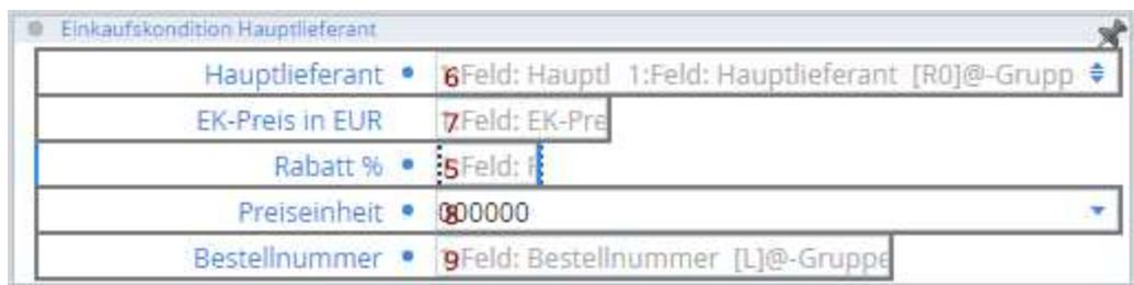
der Menü-Funktion **Tabposition setzen**, um die Reihenfolge in der Gruppe anhand der X/Y Positionen der Eingabefelder zu setzen.
