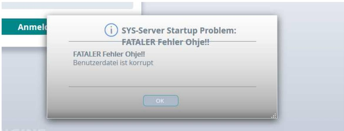
Wird die Fehlermeldung beantwortet so wird das Ergebnis direkt an die WWSYSSRV.exe übergeben so dass das Programm Aufgrund der Beantwortung weiter arbeitet.
